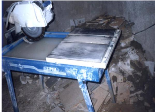
*Ilustración 4. Mesa de corte en húmedo. Fuente: (Fundación laboral de la construcción, 2019)*
